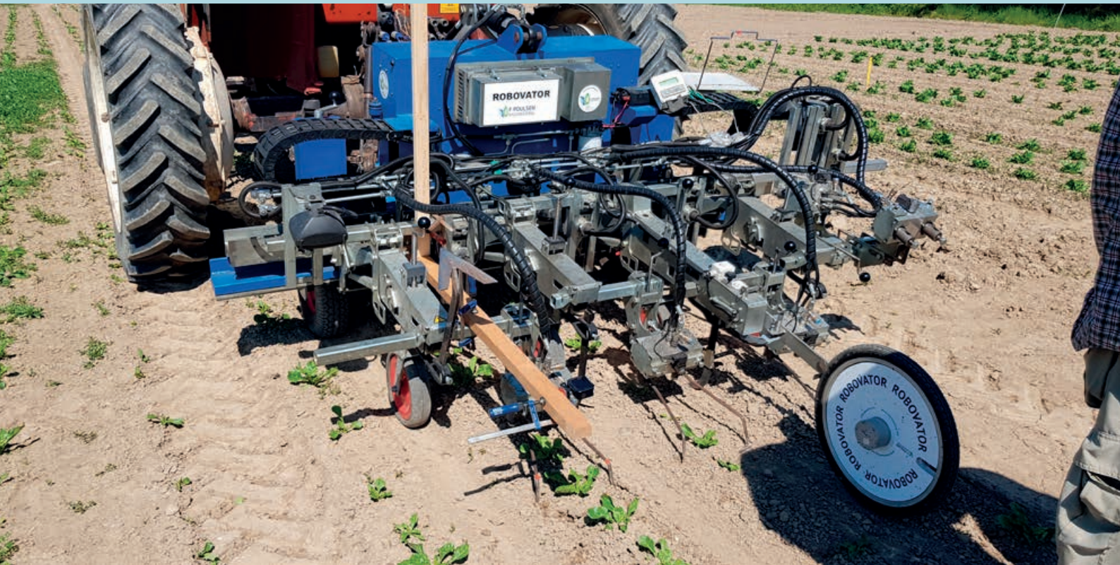
Foto 1. Robovator monteres i traktorens 3-punkts-ophæng og drives af PTO-akslen. Et kamera over hver række styrer lugeskærrernes vandring ind og ud af rækken. For yderligere info henvises til forhandlerens hjemmeside: ( visionweeding.com/robovator-mechanical ).
