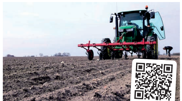
Skorpebrydning over rækken den 13. april. Fire forsøg blev kørt igennem med skorpebryderen under gode betingelser – inden roerne begyndte at danne topspire (se en video af dette arbejde på NBRs Facebook side).
