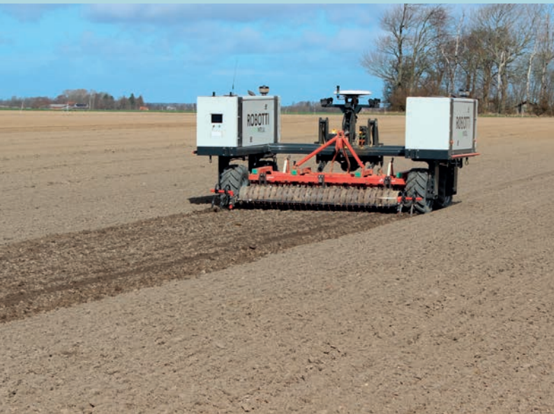
Billede 2. Såbedsharvning udført med Agrobot Robotti og modificeret harve.
