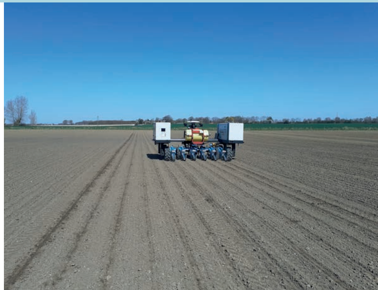
Billede 3. Roesåning udført med Agrobot Robotti.
