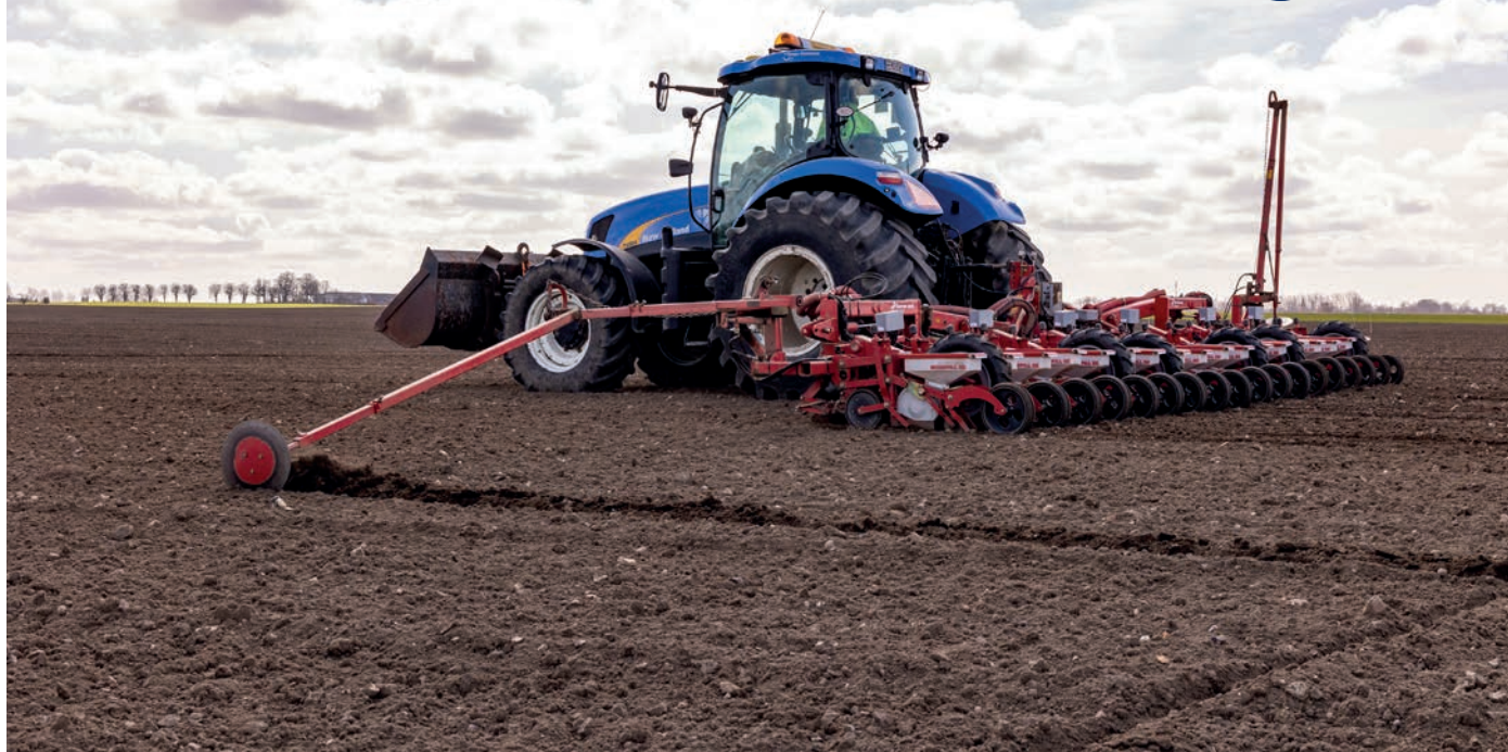
Billede 1: Gode betingelser! Såningen blev udført den 8. april med en 18-rækket Kverneland Accord Monopill med elektrisk styret tildeling.
