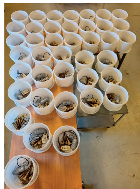
Sorternes respiration måles tidligt og sent på sæsonen med kuldioxidloggers.
