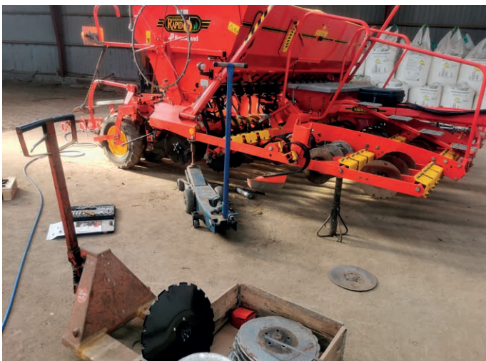
Klargøring af kornsåmaskine – 48 nye discs og 240 nye bolte.
