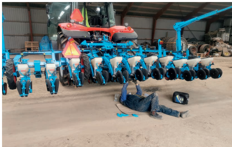
Klargøring af roesåmaskine – 12 nye slæbeskær.
