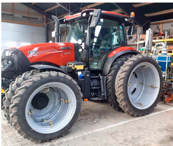
Foto 1. I 2020 var det tid til at udskifte de to gamle Valtra'er M120 til fordel for 2 stk. Case IH 145. De nye traktorer udmærker sig på mange måder og herunder de ekstra store hjul, som reducerer pakningsskader ved blandt andet såning og høst af parcellerne. På traktoren sidder en såkaldt sortsåmaskine. Det er en ombygget Stanhay, hvor det er muligt at skifte røefrø fra parcel til parcel.
