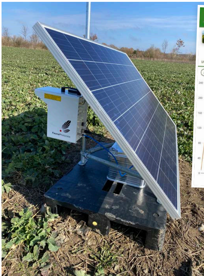
Sensor fra ”FaunaPhotonics” til registrering af insekter i marken.
