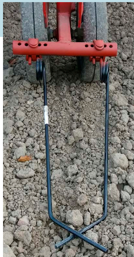
Foto 1. To vandrette strigler er en yderst simpel teknik til blindstrigling, der dog kræver aktiv redskabsstyring eller manuel styring for at sikre, at striglerne følger roerækken. I praksis monteres striglerne ofte således at de efterfølges af fingerrensere, hvorved man opnår en kombinationseffekt og bedre kan styre mængden af jord, der efterlades over roefrøene.
