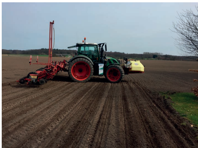
Den 18 rækkede Kverneland med 1.300 liters gødningstank skal så 500 ha roer til den kommende sæson.
