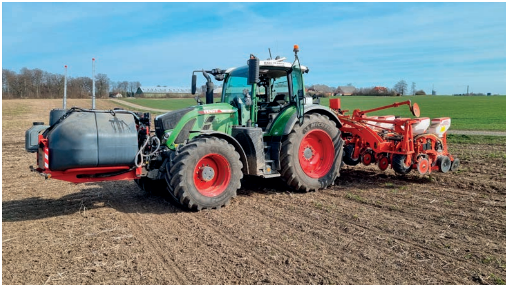
Roerne sås med en Gaspardo 12 rk. Vackum med gødningsudstyr.
