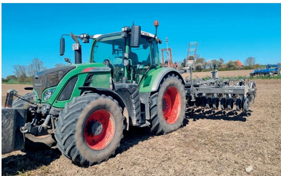
12 rækket StripCat som bl.a. skal bruges til lave striber til såningen af roerne.
