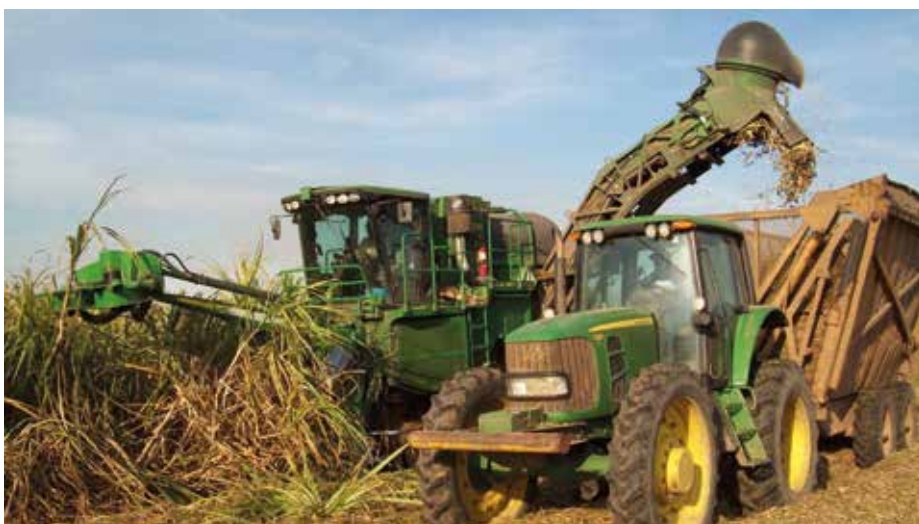
Høsten af sukkerrørene strækker sig fra slutningen af september til marts. Høstmaskinen skærer sukkerrørene i stykker på ca. 30 cm's længde og blæser dem over på en transportvogn.
