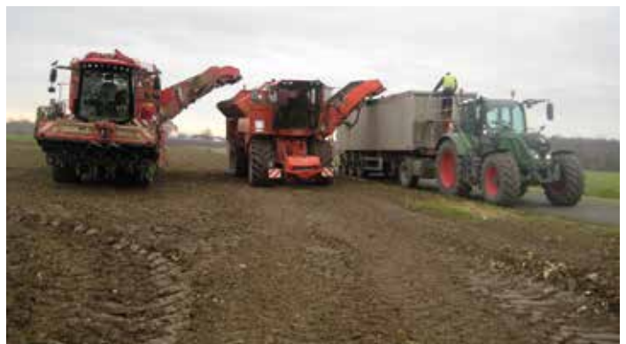
Direkte levering af roer fra henholdsvis roeoptager til lastvogn og fra frakørselsvogn til vogn.
