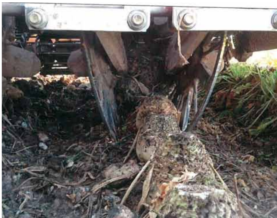
På billedet ses det særligt udviklede oppeljhjul, der kan håndtere roer op til 7,5 kilo, som er standard i Imperial Valley, Californien.
