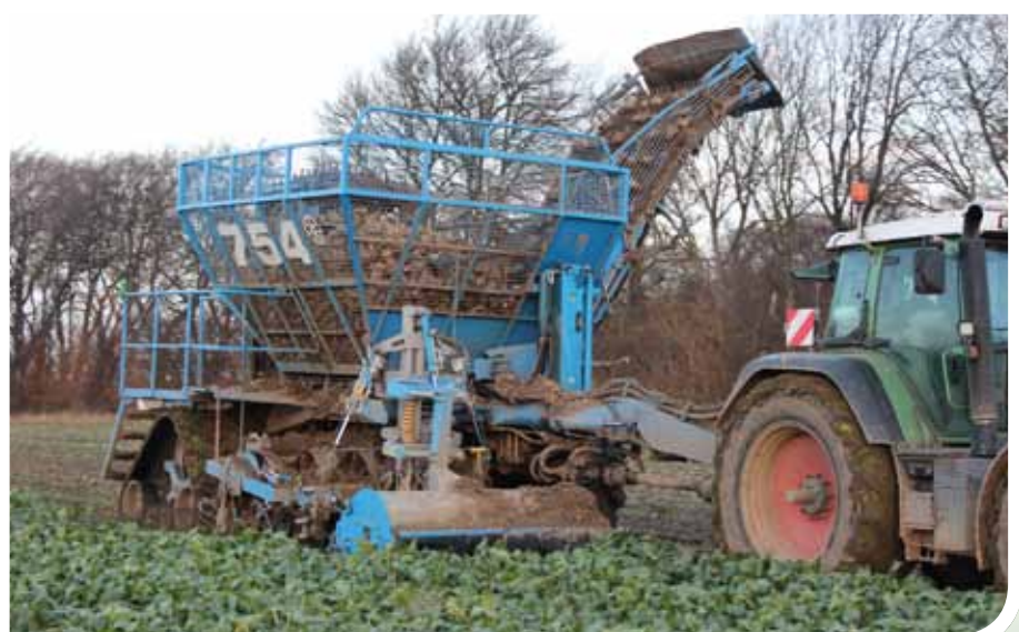
Skånsom roeoptagning med en Edenhall 754 monteret med Zuidberg bælter i højre side. Maskinsættet vejer ca. 1/3 af de største selvkørende roeoptagere.
