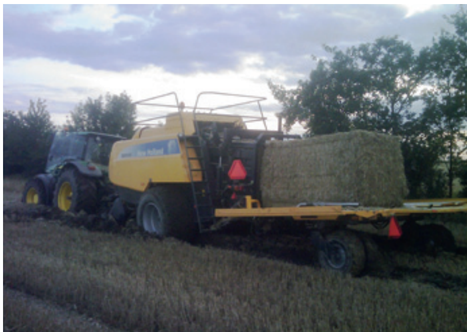
Et typisk billede fra høsten hvor presseren sidder fast. Efterfølgende blev der sat tvillingdæk på traktoren, hvilket hjalp meget.
