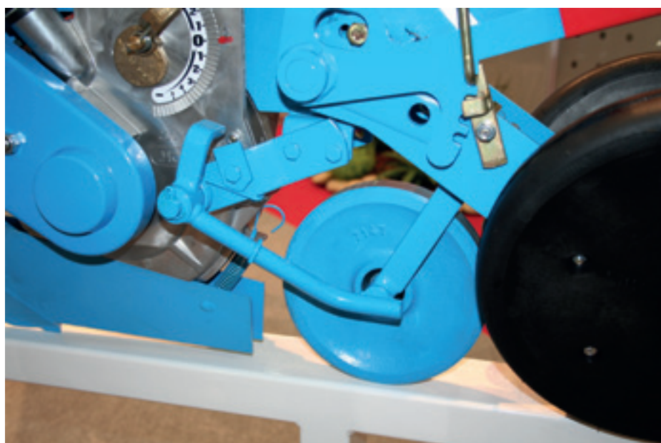
Billede 2: Såenhed fra Monosem, med kraftigt mellemtrykrulle. Foto: Otto Nielsen, NBR
