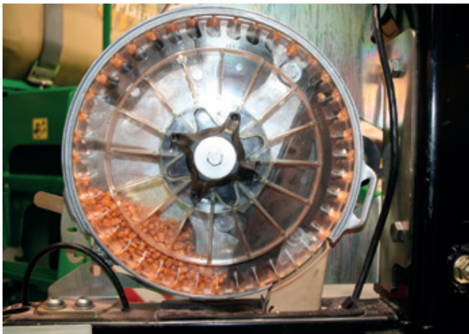
Billede 1: Såenhed til majs fra Great Plains, der viser vacuum-teknik i en moderne enkorns-såmaskine. Foto: Otto Nielsen, NBR
