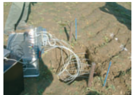
Maskinernes tryk på jorden og jordens efterfølgende pakningsgrad måles.
