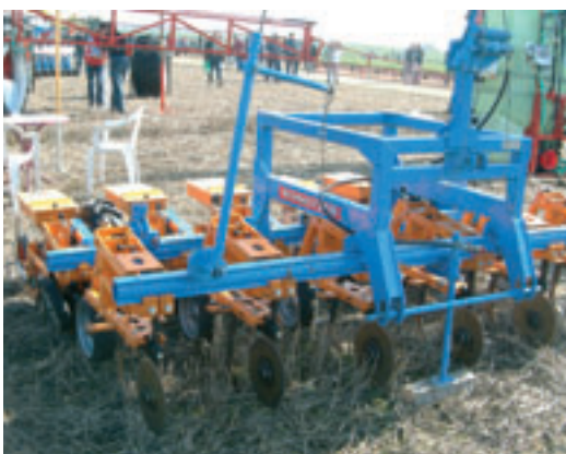
Billede 8. Det tyske firma Schmotzer har bygget en "ALCS"-harve. Harven er i 2006 afprøvet i tyske forsøg. I modsætning til Alstedgaards ALCS-harve er det med Schmotzer-versionen ikke muligt at placere gødning i forbindelse med såning. Billedet er taget af Brian Bacher Pedersen ved roehøstdemonstration i Seligenstadt i Tyskland.
