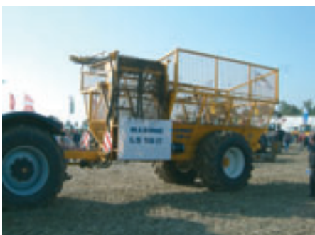
Kleine LS 18-II er en elevatorvogn på 28m 3 med en lasteevne på 18 tons, men den har kun en aksel.
