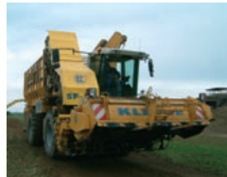
Kleine SF 20 med ny form for kitskær, der løsner jorden omkring roen og fører roerne skånsomt ind på renselæsserne.
