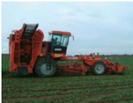
Matrot M41 en fransk selvkørende optager kun med buffertank.
