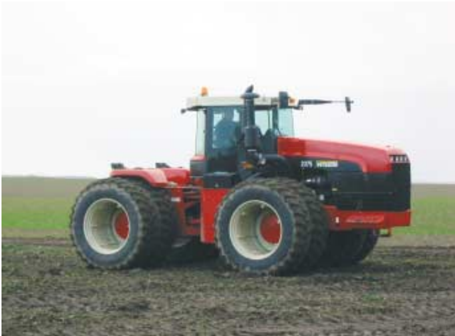
Buhler Versatile 2375. Knækstyret traktor på 375 HK blev også demonstreret på Wedellsborg.
