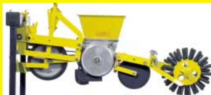
Præcis dybde og nem indstilling med parallelogramophæng
