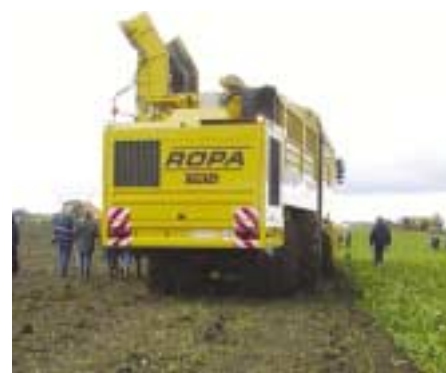
Skånegang er en måde at få fordelt marktrykket fra de tunge optagere til så bredt et areal som muligt. Her demonstreret af Ropa euro Tiger.
