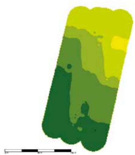
Figur 3. Markkort af biomasse i roemark genereret af Yara N-sensor. I øverste højre hjørne af marken var der problemer med rodbland og derfor mindre biomasse.
