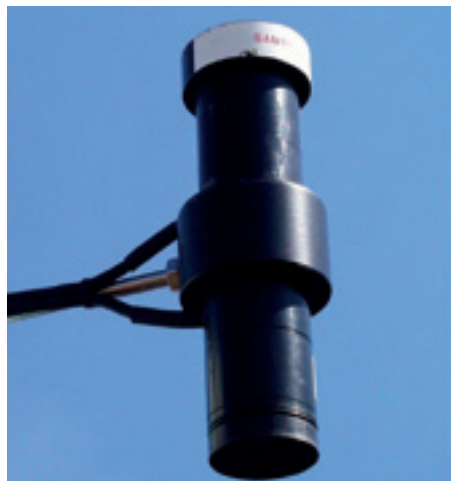
Billede 1. Sensoren, der benyttes til reflektansmålingerne i projektet.
