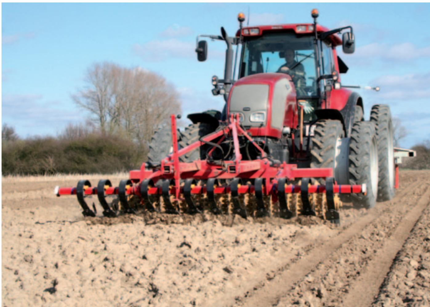
Billede 3. I pløjjord anvendtes frontmonteret Crosskill-valse.
