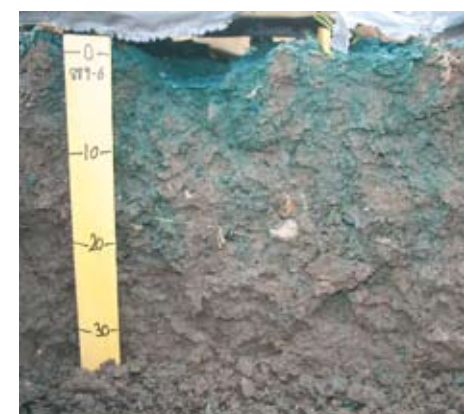
Billede 7a/7b. Farvens fordeling i jorden kvantificeres ved udgravning af profil og efterfølgende analyse af fotografi. På billedet for oven er der anvendt ALCS-tand med 15 cm vinger. På billedet nederst er der ikke brugt tand.
