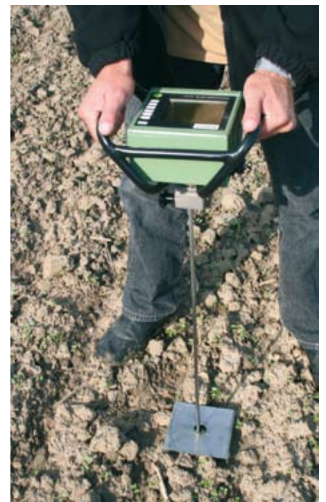
Billede 3. Avanceret penetrometer (Penetrologer) til måling af modstand i jorden. Apparatet har indbygget datalogger som registrerer sammenhørende værdier for dybde og modstand. Målingerne er foretaget ved markkapacitet. Apparatet er venligst udlånt af Institut for Jordbrugsvidenskab, KVL.
