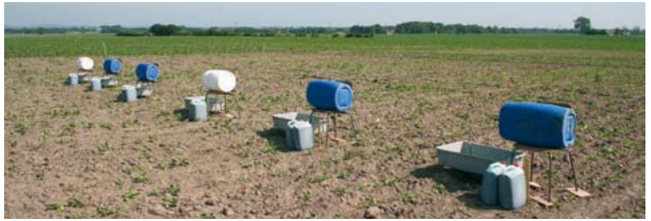
Billede 5. Udstyr til opvanding og farvning af observationsfelter. Der er boret huller i karrene, hvorfra vandet drypper ned på jorden. Hastigheden, hvormed vandet tilføres jorden, reguleres med en hane på tønden.
