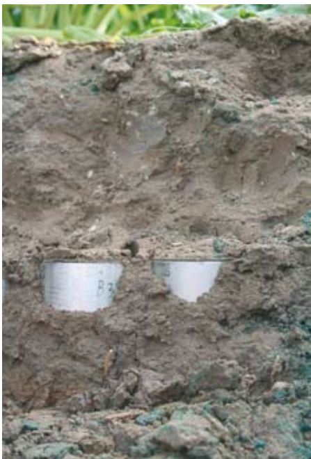
Billede 2. Jordens densitet bestemmes ved at udtage cylinderprøver. Cylinderen bankes i jorden og jorden i cylinderen tørres og vejes og densiteten udregnes ved at dividere med cylinderens rumfang.
