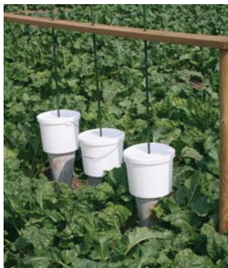
Billede 4. På Alstedgaard anvendes i år betonkegler til at registrere jordens modstand. Spandene kan fyldes med f.eks. sand for at øge trykket.
