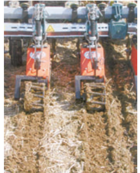
Nyt etableringskoncept kræver nye maskintyper. Her en rækkefræser brugt til en type mulchsaat forsøg i Tyskland hos IfZ (Institut für Zuckerriübenforschung).
