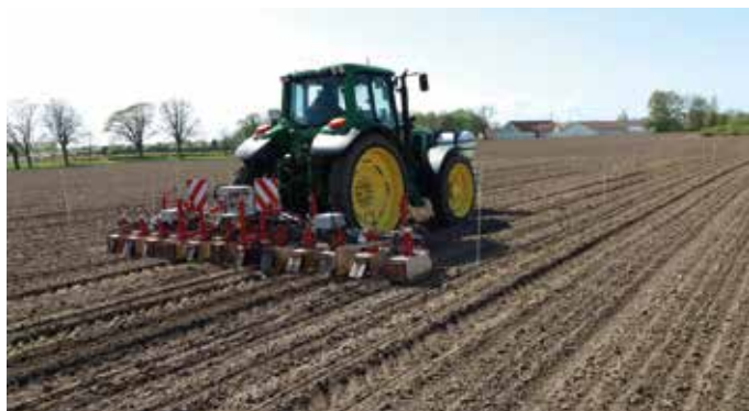
Foto 2. Forsøg med falsk såbed og blindbearbejdning med blandt andet rækkebrænder (t.v.) og ukrudtsstrigle.
