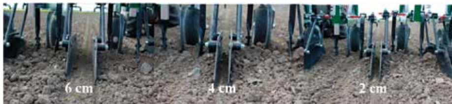
Billedet viser radrenserens indstilling i de forskellige led. Indstillingerne var 2, 4 og 6 cm fra rækken, dvs. at sidebladernes afstand imellem hinanden var 4, 8 og 12 cm.
