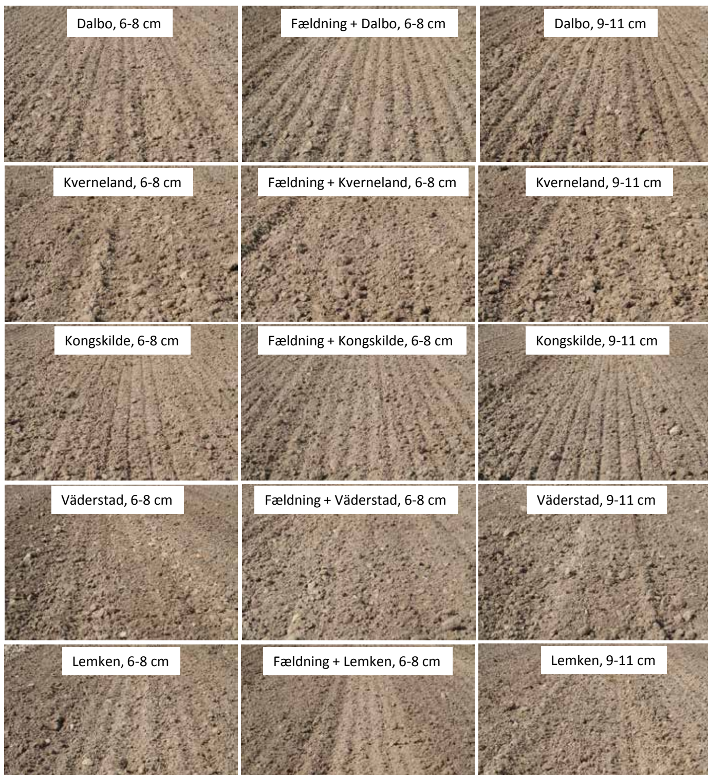
Figur 1. Såbed efter harvning med fem forskellige såbedsharver. Fældning blev udført dagen før med harve af samme fabrikat for hver af de fem deltagende harver. Harverne er nærmere beskrevet i teksten.
