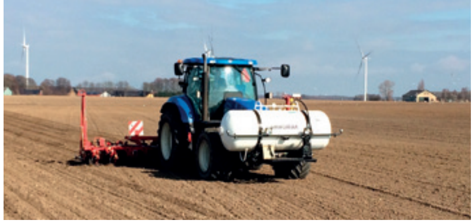
Roesåning med Kverneland Monopill 12 rk. med placering af flydende ammoniak.
