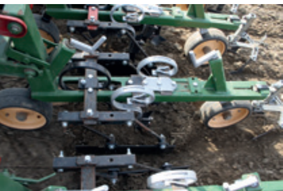
Foto 3. Det bagerste hjul har til formål at genpakke jordens, hvis dette er nødvendigt, og findeler jorden yderligere ved at knuse knoldene. Den bagerste enhed samler jorden i en lille vold og efterlader det øverste jordlag relativt knoldet, hvorved risikoen for tilslemning reduceres.
