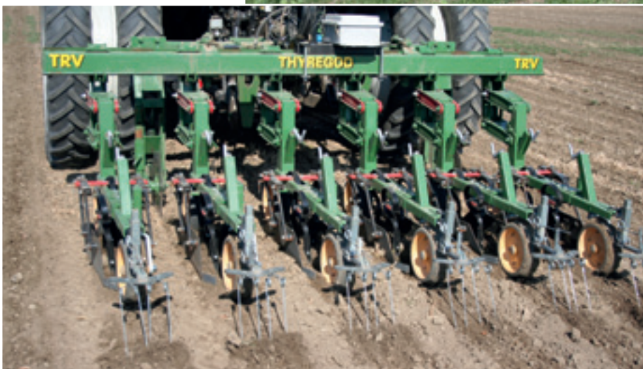
Foto 3. Thyregods TRV-radrenser er ombygget til rækkebaseret (strip-tillage) såbedsharve ved at montere et ekstra hjul bagerst samt ved at erstatte radrensertanden med tre såbedsharvetænder.
