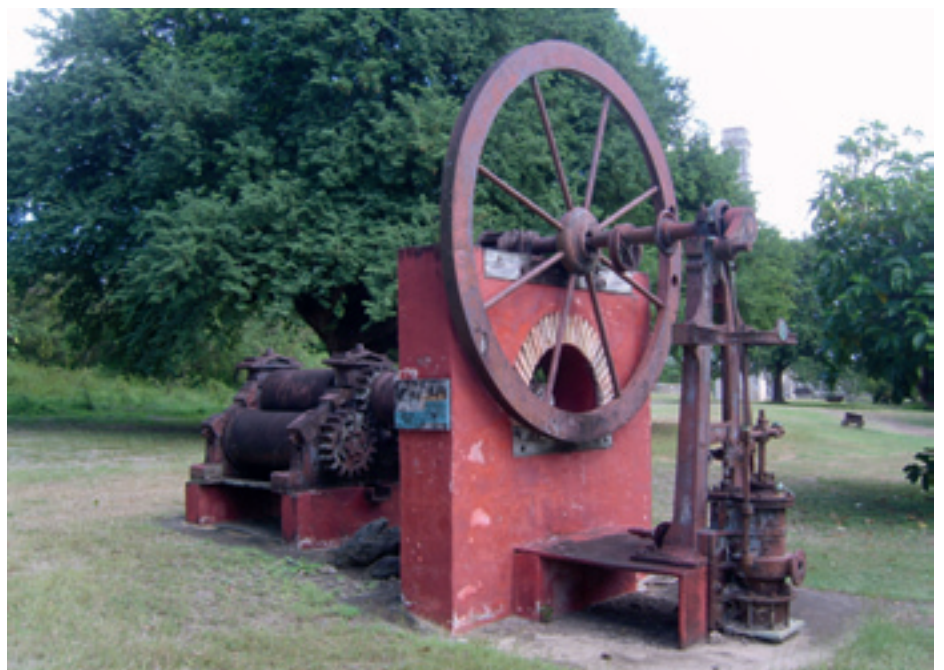
Der var tale om en simpel proces, hvor vindmøllen trak nogle valser, som pressede saften ud af sukkerrørene.
