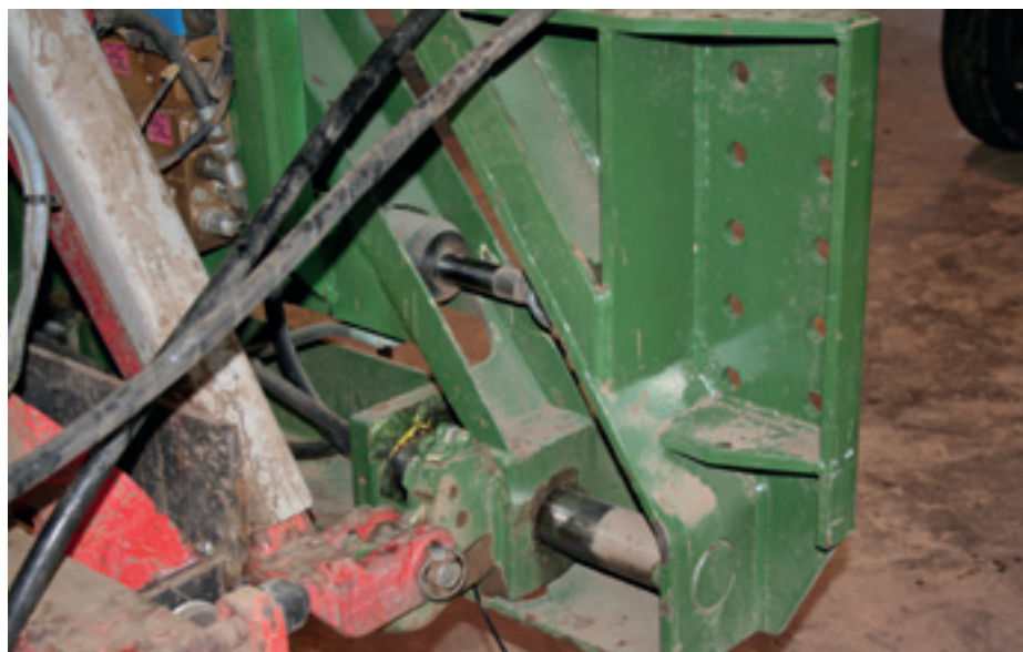
Foto 6. Specialfremstillet sideforskydningsenhed fra Thyregod, som anvendes til redskabsstyring ved hjælp af GPS. Dette øger præcisionen, idet redskabet holder det ønskede spor uafhængigt af traktorens bevægelser.
