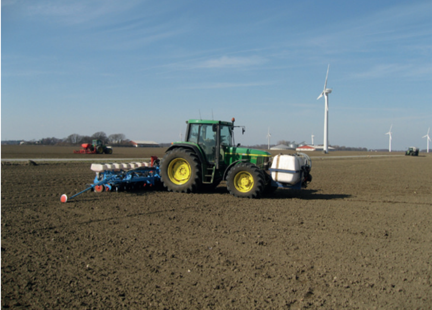
Såning med 6910'eren med 1.500 l fronttank og roesåmaskinen Monosem NG3+. På marken bagved køres med 4 m Kuhn rotorsættet, og i baggrunden ses Vesterlund og Nygård.
