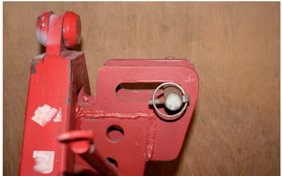
Billede 5. Aflangt topstangshul sørger for, at ujævnheder ikke overføres fra traktor til redskab.
