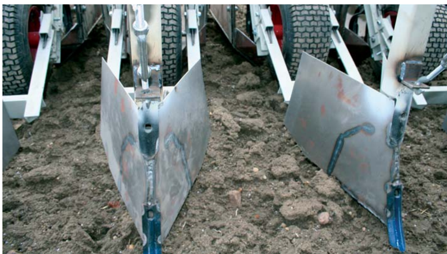
Billede 5. Til at fjerne væltede stængler af gul sennep er seks tidligere hyppeløve blevet bygget om. Plovene er ophængt i parallelogram og dybden styres af et hjul (skjult bag pladerne). Harvetanden rører netop jordoverfladen og sikrer (forhåbentligt) at plantemateriale fjernes fra rækken.
