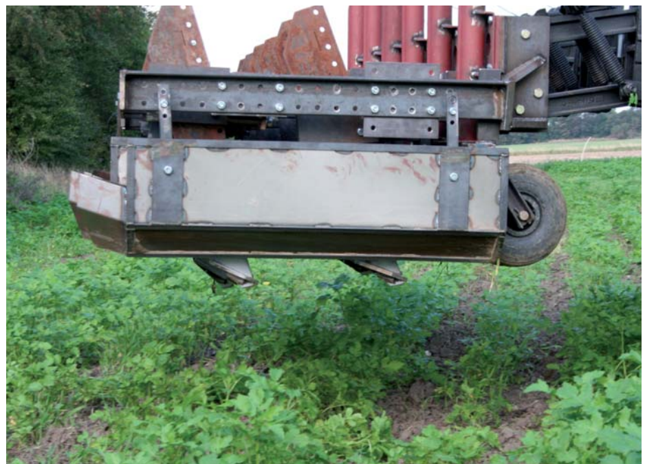
Billede 6. Eksempel på anvendelse af forsøgsredskab. Der er monteret to kraftige tænder til at bearbejde jorden i indtil 20 cm. Skærmene holder jorden samlet omkring rækker og beskytter en eventuel efterafgrøde (billede 1).
