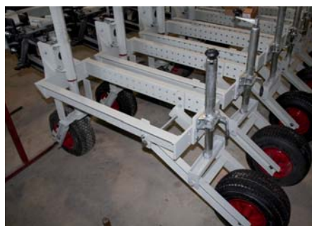
Billede 3. Hver enkelt ramme kan monteres med forskelligt udstyr ved at bolte det på. Dermed kan redskabet relativt nemt bygges om. Der er højdehjul forrest som standard, og derudover kan der for eksempel monteres højde-/pakkehjul bagerst.
