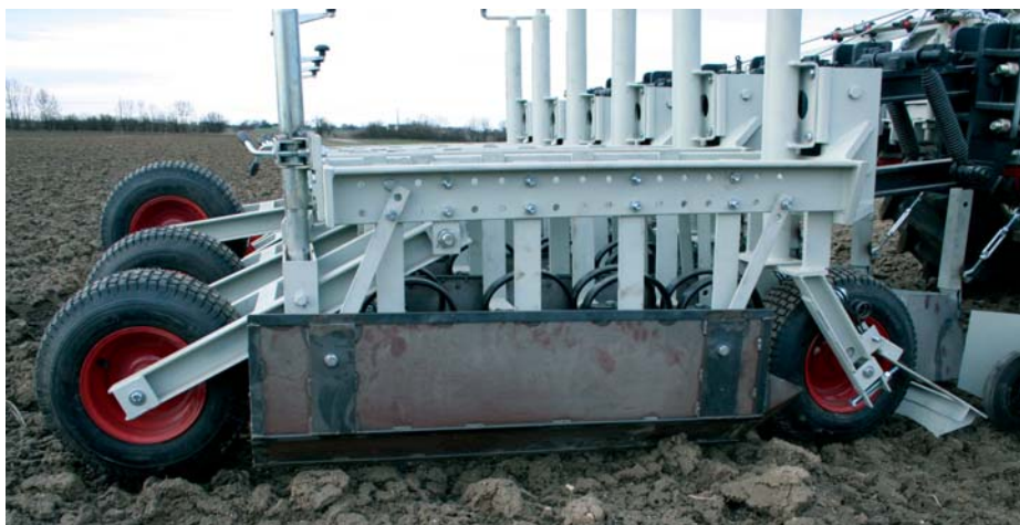
Billede 4. Det fleksible forsøgsredskab (se foregående artikel) er omdannet til såbedsharve. Forrest ses enhed til at fjerne væltede stængler af gul sennep (billede 5), dernæst afretterplade, højdehjul, syv harvetænder af Germinator-typen (skjult bag skærm (billede 6)) samt højde- / pakkehjul, som om nødvendigt kan erstattes med valse.
