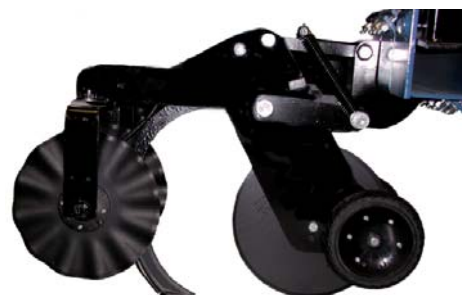
Billede 5. Maskiner til partiel bearbejdning er oftest baseret på parallellogramophæng. Her et eksempel fra Redball.
