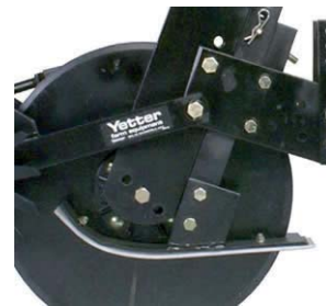
Billede 8. Til forsøgene i 2008 med efterplacering af gødning anvendes udstyr fra Yetter. Forrest sidder en 46 cm skive, hvis dybde reguleres af "ski".
