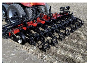
Billede 1. I USA fremstiller en række maskinfabrikanter maskiner beregnet til partiel bearbejdning (strip tillage). Her ses en udgave fra Unverferth.
