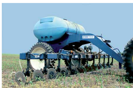
Billede 3. I USA er det udbredt praksis at efterplacere en del af gødningen efter fremspiring. Den viste maskine er fra Thurston (blu-jet).
