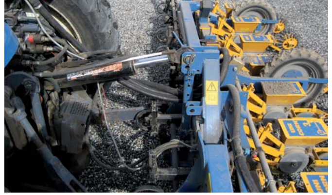
Forsøg med hydraulisk topstang til indstilling af sådybden ved roesåningen.
