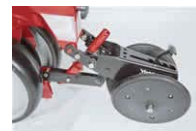
Billede 9. Til pakning af den efterplacerede gødning i forsøgene monteres hjulpakkermodul fra Yetter, hvor vinkel og tryk på hjulene kan justeres. Pakkemodulet kan også anvendes til pakning ved såning.
