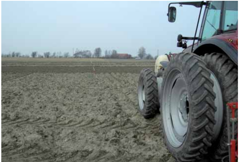
Billede 7. Traktoren trykker ikke sårækkerne. Dette er specielt vigtigt, når arbejdsbredden kun er tre meter.
