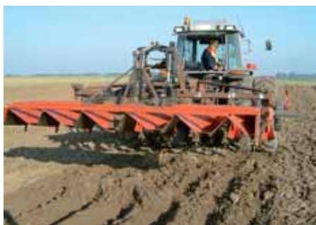
Billede 3. Etablering af efterårskamme. Udover kamplove og kamformer kan jorden under kammen bearbejdes med kraftig tand for at sikre mere ensartet jordstruktur til roerne.
