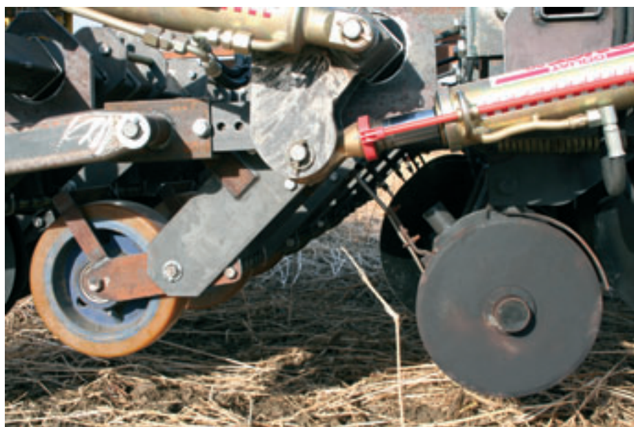
Billede 3. Gødningsrulleskær til placering af flydende gødning og pakkehjul til pakning af jord omkring gødningsrillen.
