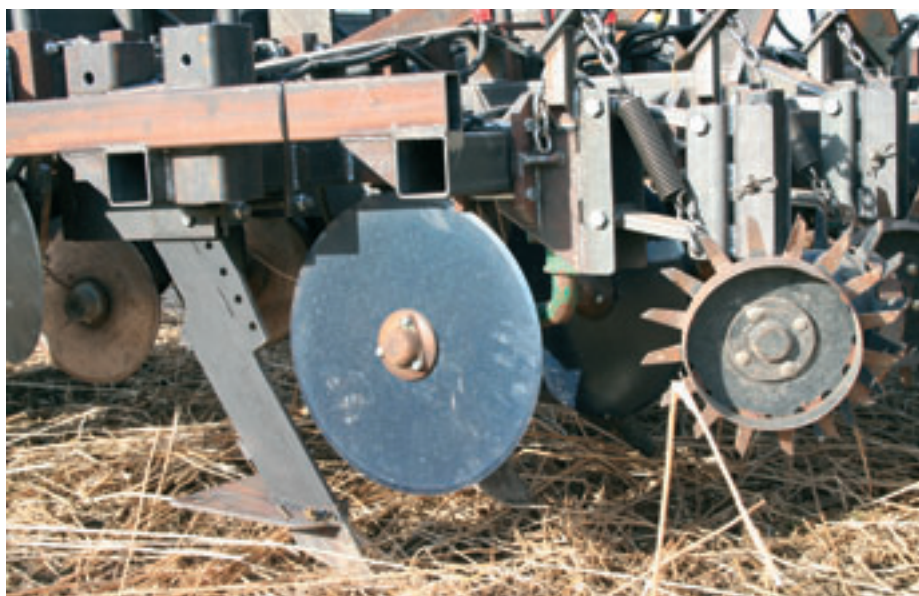
Billede 2. Forreste del af ALCS-harve med stjerneruller, rulleskær og ALCS-tand.
