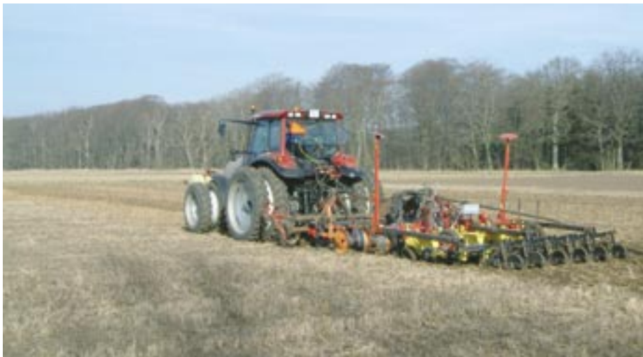
Billede 1. Kamdanneren (orange) er monteret på ALCS-harven (ALstedgaard Combi System) og efterfølges af en Kleine Direct såmaskine. Her sås i kornstub uden kam med »one pass system« bestående af ALCS-harve med forrest stjerne-hjul, herefter tand i ca 35 cm dybde, tallerkner, »Kleine Unicorn Syncro direkte« monteret med trykrullesystem til pakning af jord omkring gødning, der placeres med skiveskær.
