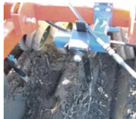
Billede 4. Til placering af gødning i kammene blev der lavet forsøg med en såkaldt »Svenskertand«. På trods af den lette udformning var tanden ikke skånsom nok overfor kammen.
