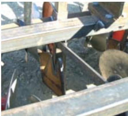
Billede 2. For at skaffe jord nok til kamdanneren blev der monteret skær umiddelbart foran denne.
