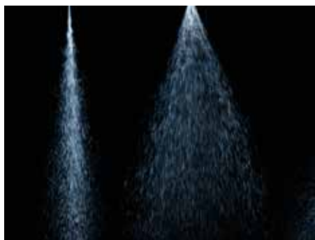
Figur 5: Foto af spredbilledet af Teejet 40-02 E dyse til båndsprøjtning. Set fra siden og forfra.
