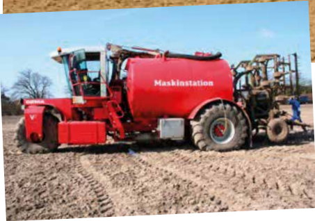
Foto 3-4. Selvkørende gyllespreder (t.v.) som blev anvendt i forsøgene vist i figur 5 (foto: Janne Aalborg Nielsen, SEGES). Producenten (Vervaet) leverer også en selvkørende frakørselsvogn (foto: Otto Nielsen, NBR).
