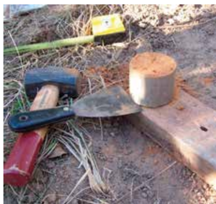
Foto 2. Pakningskader kan kvantificeres ved at udtage en jordprøve og måle tætheden af denne. Hvis den udtagne jordcylinder beholdes intakt, kan man endvidere måle jordens evne til at transportere vand eller luft (figur 2) og i en nyere undersøgelse anvendte man skanningsteknik (figur 1). Foto: Otto Nielsen, NBR.
