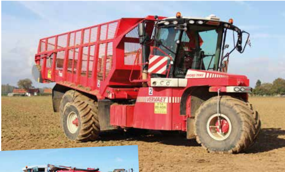
Foto 3-4. Selvkørende gyllespreder (t.v.) som blev anvendt i forsøgene vist i figur 5 (foto: Janne Aalborg Nielsen, SEGES). Producenten (Vervaet) leverer også en selvkørende frakørselsvogn (foto: Otto Nielsen, NBR).
