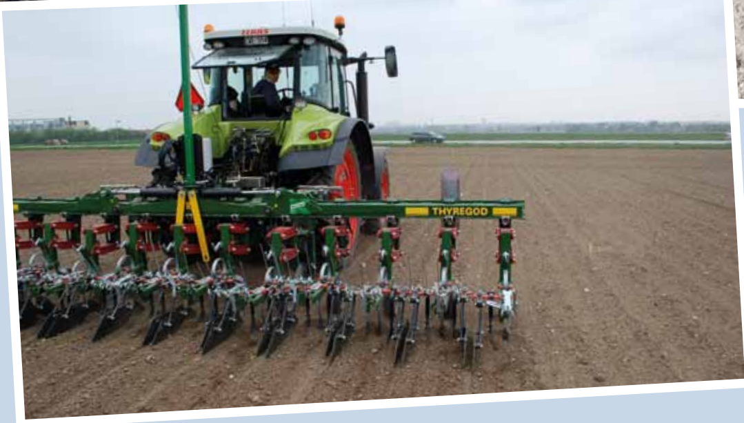
Fotos 1-4. Forsøget er udført på fire lokaliteter i Sverige, herunder NBR's forsøgsarealer på Ädelholm (øverst tv.). Der blev anvendt en 12-rækkers Thyregod TRV radrenser, som både kunne styres ved hjælp af kamera (monteret til højre på rammen) og med GPS (GPS-modtager monteret midt på rammen). Ved alle kørsler, blev der anvendt L-skær som vist på billedet. Ligeledes blev der anvendt sideplader, her vist med en indbyrdes afstand på 4 cm (nederst th.). Efterharve blev ikke anvendt ved den første kørsel (slået op på billedet nederst tv.)
