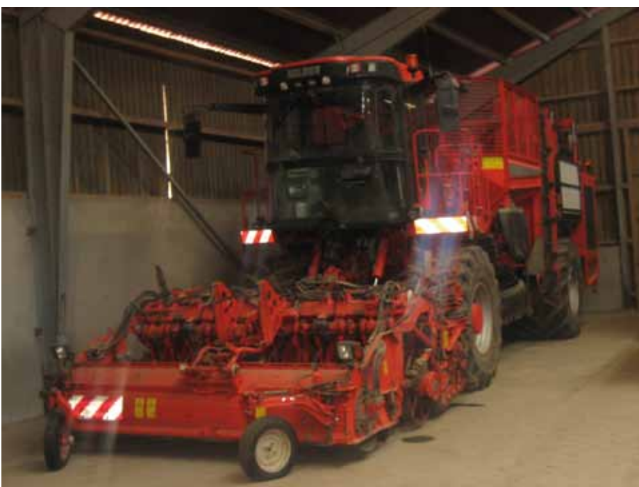
Til roesæsonen 2011 blev der som noget nyt leaset en fabriksrenoveret Holmer T-3 roeoptager fra 2006 i et år. Maskinen har taget ca. 230 ha roer op i 2011-kampagnen.
