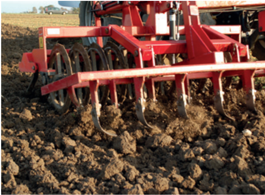
Foto 5. Albom II er frontmonteret og er konstrueret af Christian Wraghe med udgangspunkt i Albom I. Der er anvendt fræsertænder som harvetænder, og disse efterfølges af pakkevalse og slæbeplanke (Pløjboj). (Fotograf: Robert Olsson, NBR)
