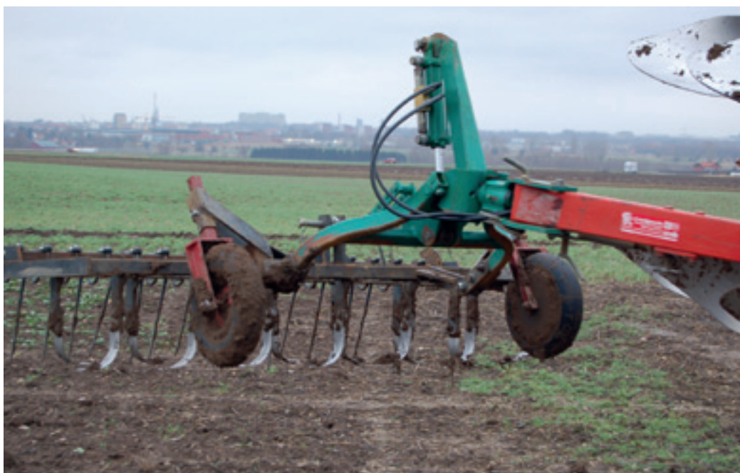
Foto 4. På Albom I anvendes fræserknive, som harvetænder. Disse er robuste og slidstærke nok til at jævne pløjeorden. Derudover er der bagerst én række kraftige efterharvetænder. (Fotograf: Robert Olsson, NBR)
