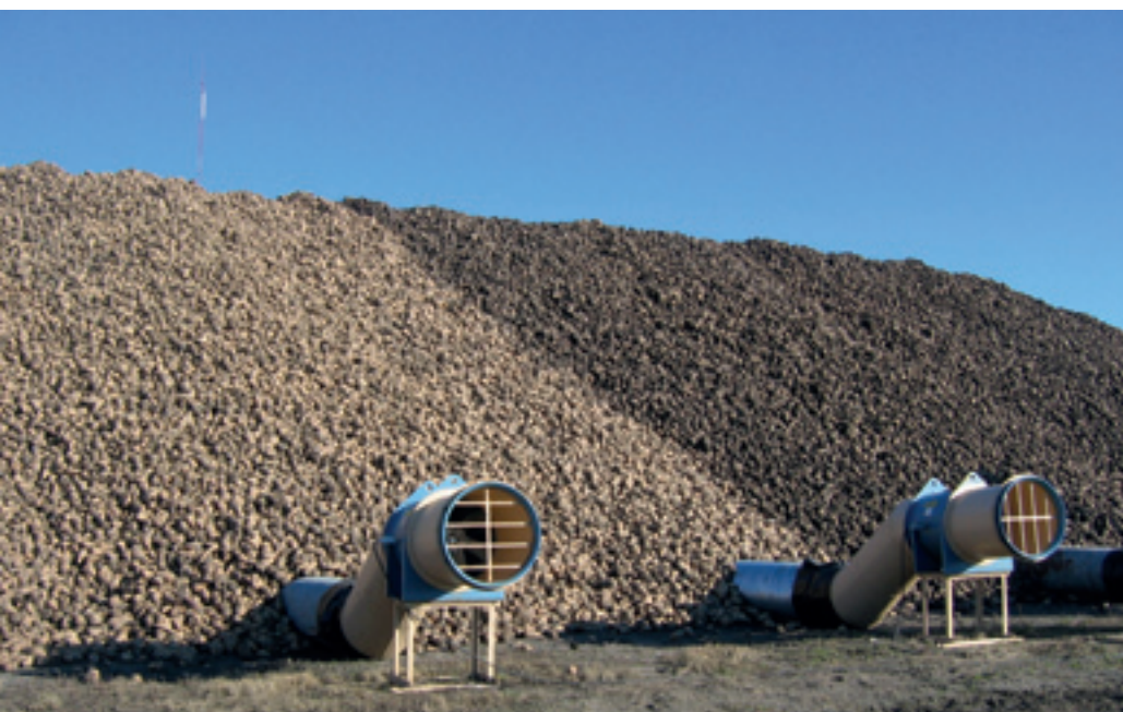
Roerne opbevares i frossen tilstand i bl.a. meget store batterier op til 10 meters højde, hvor frossen luft blæses ind i midten gennem store rør på 1 meter i diameter.
