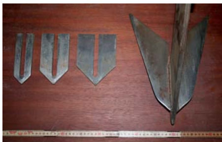
Billede 10. Hjemmelavede vinger på henholdsvis 5, 8, 11 og 22 cm. Vingerne klemmer sig selv fast omkring tanden, så det er hurtigt at afprøve forskellige vinger i forsøgs-mæssig sammenhæng.
