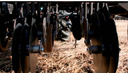
Billede 5. Alstedgaards (nu Sofiehøj) forsøgsredskab til partiel forårsbearbejdning, som det så ud i 2006 i NETE-projektet. Såmaskinen var koblet direkte på harven.
