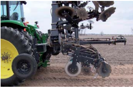
Billede 4. En af de større producenter af udstyr til partiel bearbejdning er amerikanske Yetter. Vi anvender parallelogrammer fra Yetter til vores forsøgsredskab. Fotoet er fra producentens hjemmeside.
