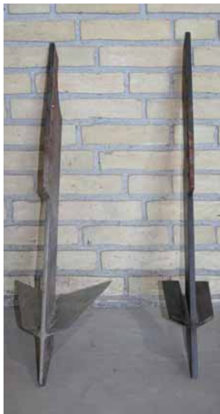
Billede 1. ALCS-tænder med to typer vinger. De præsenterede resultater er fra forsøg med tanden til højre, som har 10 cm vingefang. Endvidere blev der anvendt en tilsvarende tand med 15 cm vingefang. Tandene til venstre har tidligere været anvendt, men indgik ikke i dette forsøg
