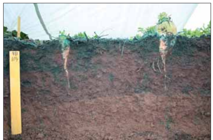
Billede 2. Jordprofil fra henholdsvis upløjet stubjord, billede til venstre, og upløjet nedvisnet gul sennep, billedet til højre (udgravning foretaget september, 2006). Farvestoffet Brilliant Blue er anvendt til at visualisere væskestrømme og porøsitet af jorden.
