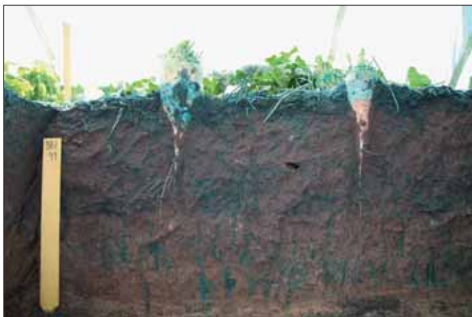
Billede 2. Jordprofil fra henholdsvis upløjet stubjord, billede til venstre, og upløjet nedvisnet gul sennep, billedet til højre (udgravning foretaget september, 2006). Farvestoffet Brilliant Blue er anvendt til at visualisere væskestrømme og porøsitet af jorden.
