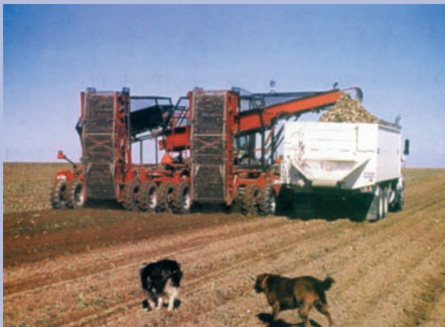
Roeoptagning med en 12-rækket traktortrukket roeoptager i USA. Maskinen er en sammenbygning af to 6-rækkede optagere, som laster en 25 – 30 tons lastbil på tre til fem minutter. Maskinen høster ca 500 ha på 14 dage!
