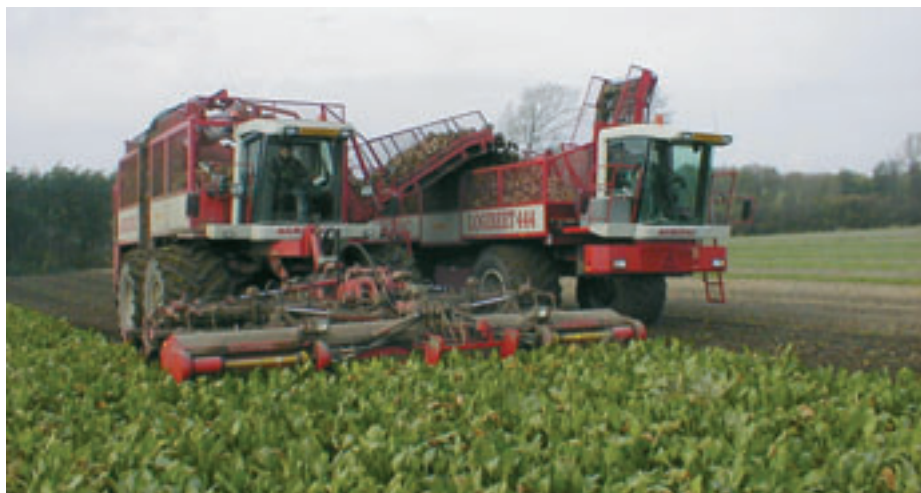
Roeoptager 12 rækket AGRIFAC HEXA og Logibeet frakørselsvogn i aktion i efteråret 2005.
