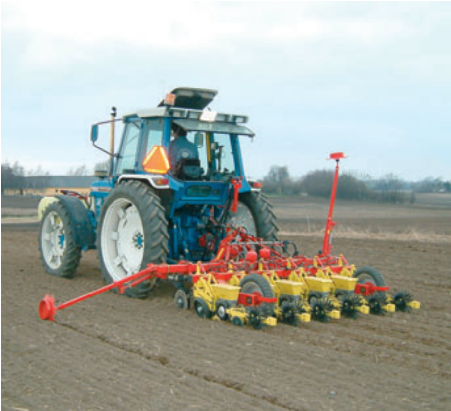
Kleine Unicorn direkt såmaskine med udstyr til placering af flydende gødning
