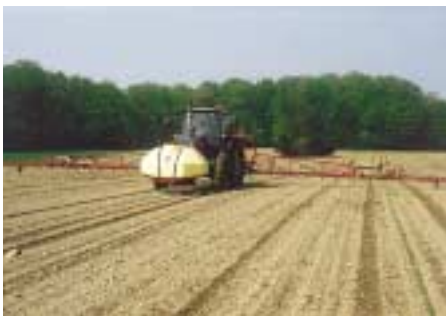
Sprøjtebom model 2002, tredelt med ét kamasæt pr. bomafsnit. Minikamera på bevægelig bom og visioncomputer på fast.
