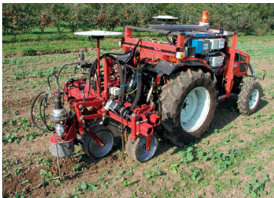
Foto 1. Ved mødet blev der vist et filmklip af en intelligent fingertandsharve udviklet af blandt andet Michael Nørremark, der ud fra et digitalt frøkort kan luge ukrudt væk i rækken. Maskinen kender roeplanternes placering ud fra det digitale frøkort og ved automatik harves udenom med op til 1,8 km/t og uden fører. Præcisionen er den samme som for RTK-GPS, dvs. op til 2 cm.
